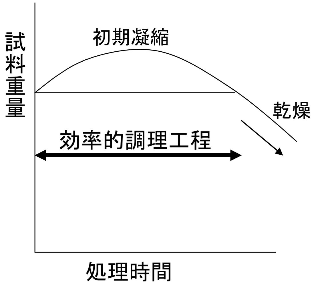
図1 過熱水蒸気加熱処理での試料重量変化
