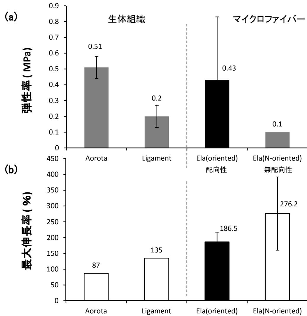
図5 生体組織および配向性エラスチンマイクロファイバーの力学特性
