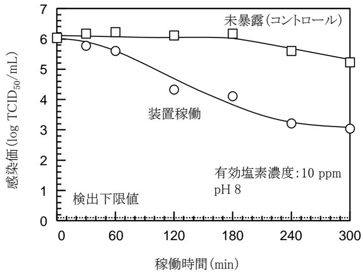
図10. 電解次亜水を内部生成する通風気化装置を稼働したときの乾燥シャーレ上のネコカリシウイルスに対する吹き出し空気の不活化効果
