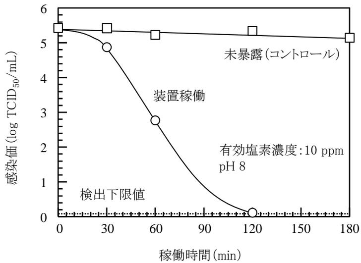
図9. 電解次亜水を内部生成する通風気化装置を稼働したときの乾燥シャーレ上のA型インフルエンザウイルスに対する吹き出し空気の不活化効果
