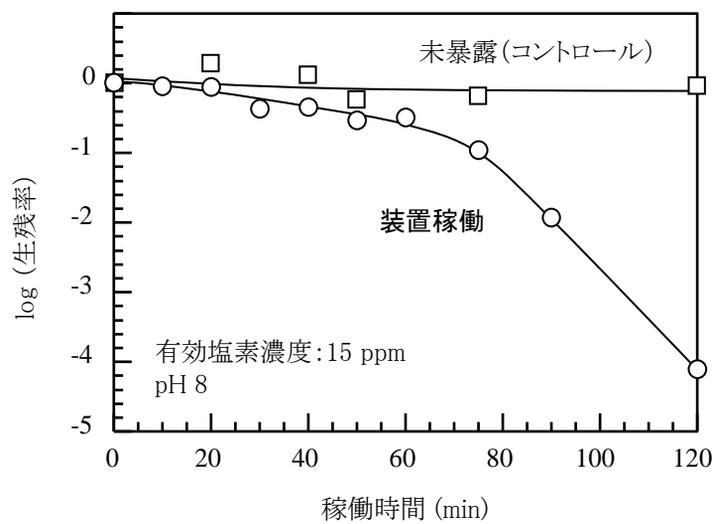
図8. NaOCl 水溶液を供給した通風気化装置を稼働したときの乾燥シャーレ付着菌に対する吹き出し空気の殺菌効果
