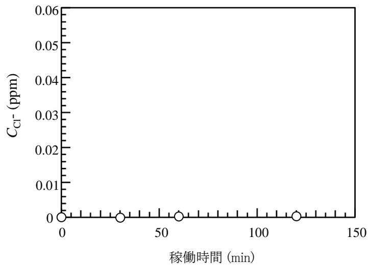
図3. NaCl水溶液(16 ppm)を供給した通風気化装置を稼働したときの $C_{Cl^-}$
