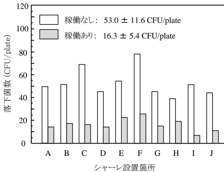
図2. NaOCl水溶液を供給した通風気化装置を稼働させたときの落下菌数の変化
