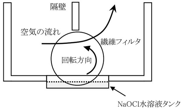
図1. 次亜塩素酸水溶液を用いた通風気化システムの模式図
